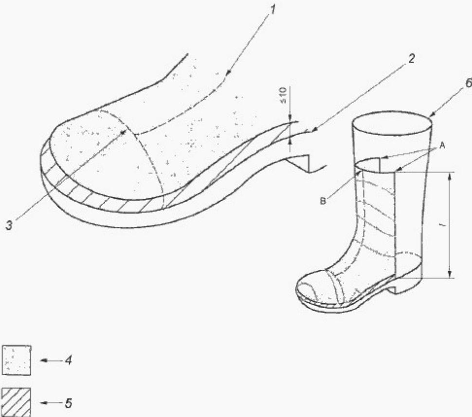
1 — геометрическая ось обуви; 2 — линия кромки; 3 — спинка носка; 4 — защитная область; 5 — дополнительная защитная область для обуви уровней защиты 3 и 4; 6 — верхний край верха обуви
