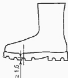
Рисунок В.1 — Трещины на подошве
