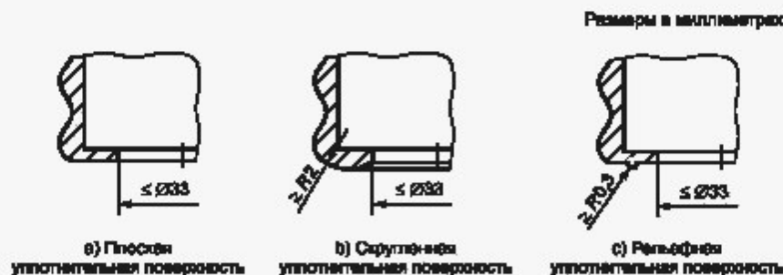
Рисунок 2 — Уплотнительная поверхность соединителя с наружной резьбой
